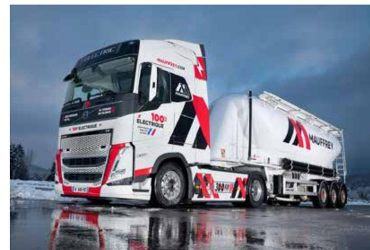
L'FH Electric 44T ha un carico utile di 26,5 T. Con una potenza di 490 kW (ovvero più di 660 CV), sulla motrice sono installati 3 motori e 6 batterie.
